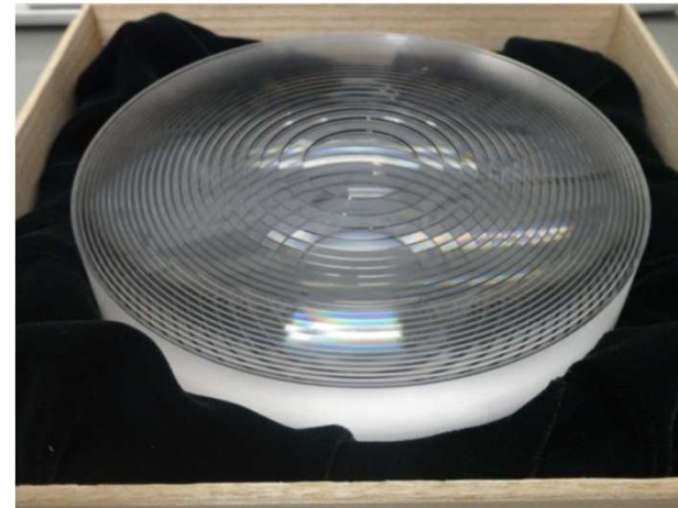
Acrylic fresnel lens mold 【Ikegami Mold Engineering】
