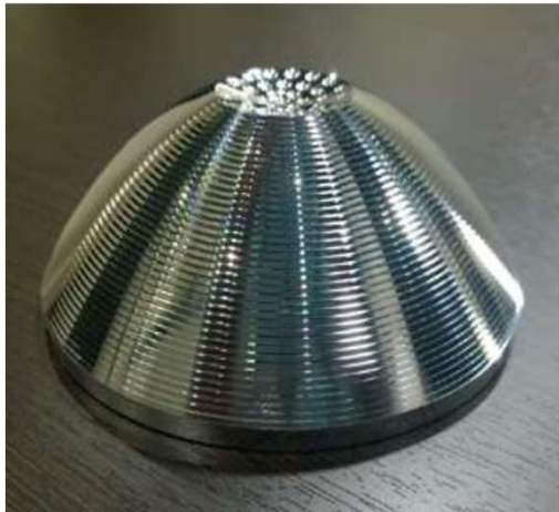
Ni-P Micro lens array mold 【Kyohei Engineering K.K.】
