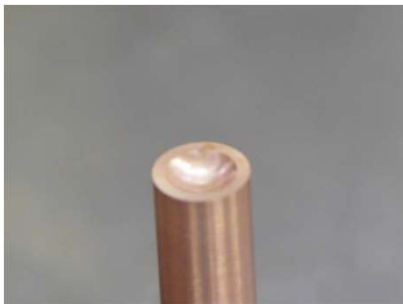
Ni-P Aspherical lens mold 【Riken Corp】
